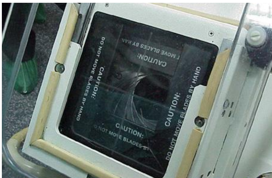
Σχ. 17: Συνδυασμός επίπεδων διαφραγμάτων και διαφράγματος τύπου ίριδας.
