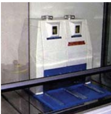
Σχήμα 90: Θωράκιση γεννήτριας ^{99m}\text{Tc} .
