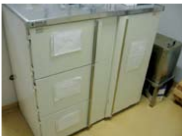
Σχήμα 87: Θωρακισμένη κρύπτη φύλαξης ραδιοϊσοτόπων.
