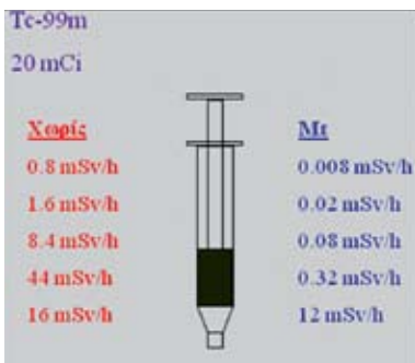
Σχήμα 94: Ρυθμοί δόσης σε διάφορα μέρη της σύριγγας με και χωρίς τη χρήση καλύπτρας.
