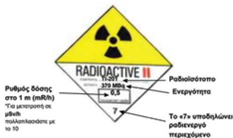
Σχήμα 107: Παράδειγμα σήμανσης δέματος κατηγορίας Yellow II.
