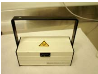
Σχήμα 98: Θωρακισμένο δοχείο μεταφοράς ραδιοφαρμάκων.
