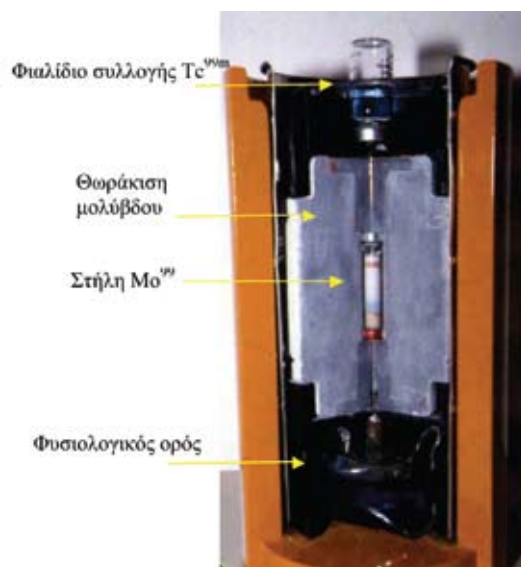
Σχήμα 71: Τομή γεννήτριας παραγωγής ^{99\text{m}}\text{Tc}
